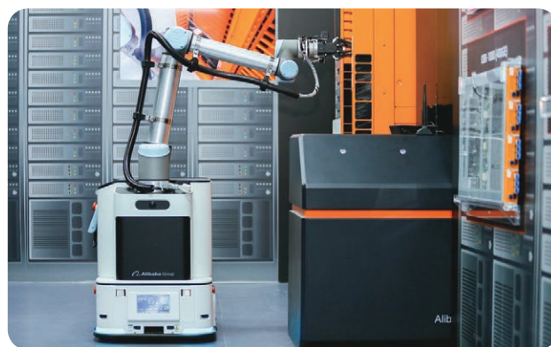
▲ 阿里雲運維機器人天巡具備機械臂控制能力，使數據中心運維效率大幅提升。
